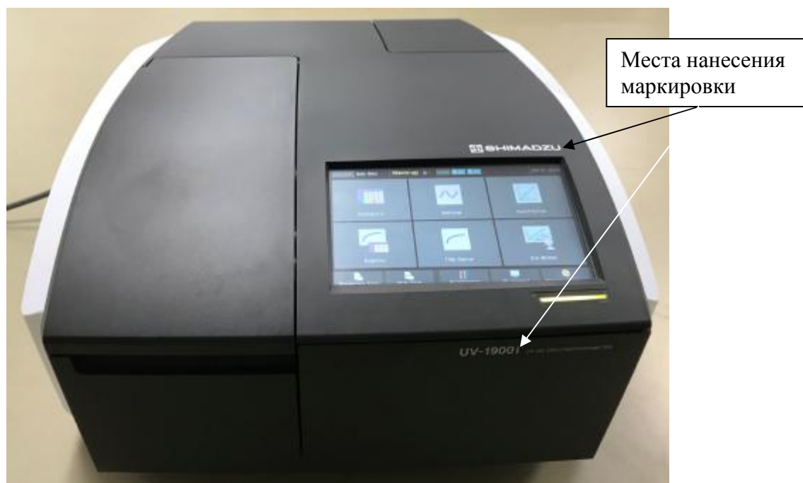
Рисунок 2 - Общий вид спектрофотометров UV-1900i с обозначением места нанесения маркировки
