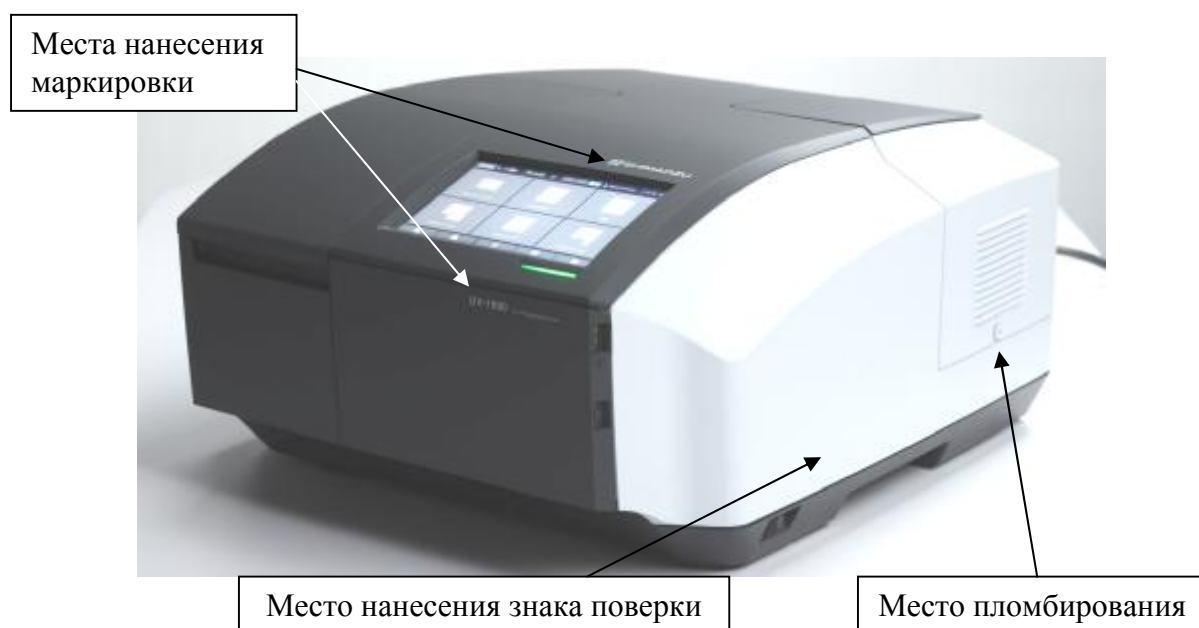
Рисунок 1 - Общий вид спектрофотометров UV-1900 с обозначением места нанесения маркировки
